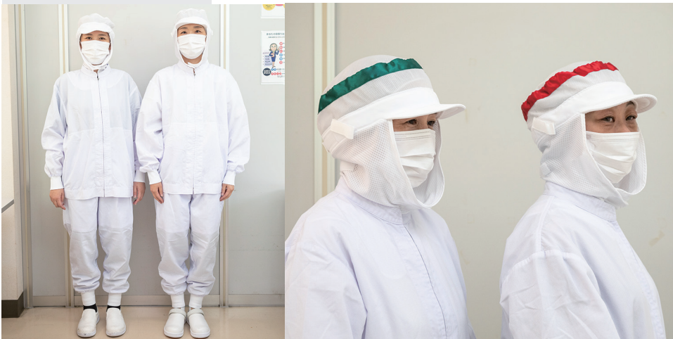
首元まで布地で覆う帽子、インナーメッシュの付いた上着、リブで締まっている手首と足首で、抜けた毛髪や体毛がユニフォームの外に出ない仕組み。
